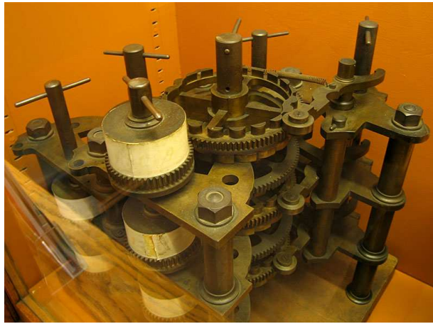
Figura 2: La macchina differenziale
